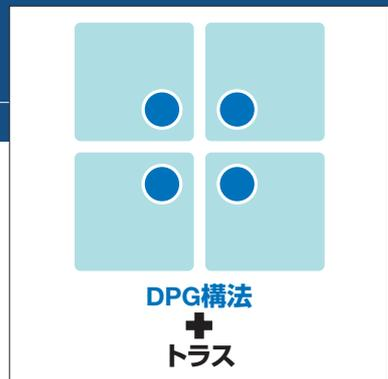
ここには支持構法の異なる2つのガラスのキャノピーがある。エントランス周りに大きく張り出すキャノピーは、水平に使われたDPG構法をシステムトラスで上部から吊る支持構法により、象徴的な存在感を示している。一方、動く歩道の入口にあるキャノピーは、システムトラスで下部から支持している。この2つのキャノピーは、水平に利用するDPG構法の支持が、上下いずれからでも自在であるこ
